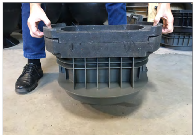
leichte Zugfestigkeit zwischen den Bauteilen vorhanden
