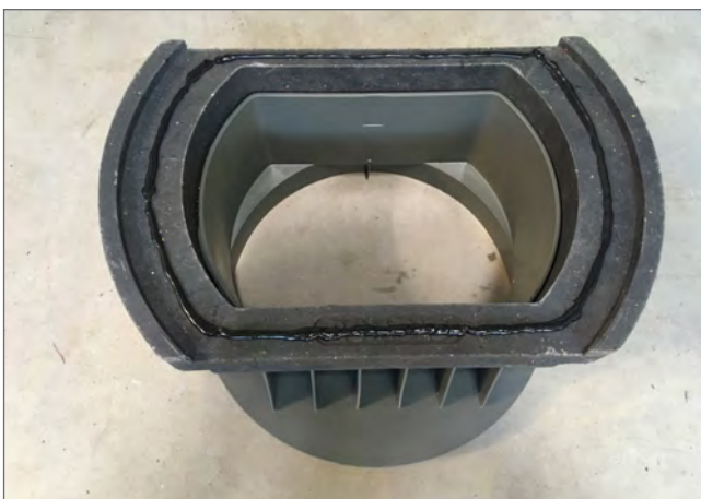
Kleber umlaufend auf PDRD 50.30/xx VS aufgetragen
