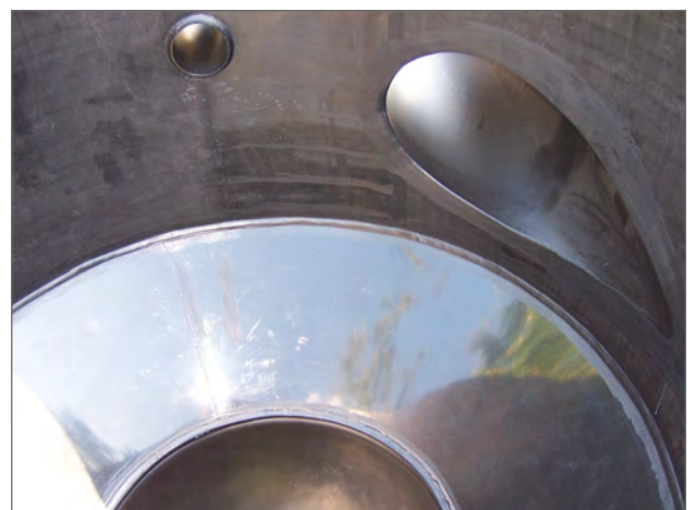
Innenansicht mit Zulaufstutzen und Rundboden
