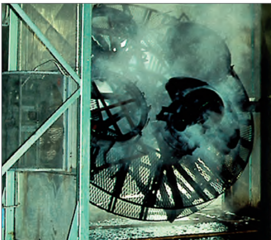
ROMOLD Produktion im Rotationsinterventverfahren (Kühlung mit Wasser)
