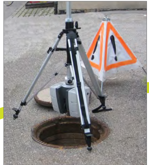
Detailliertes Schachtaufmaß idealerweise mittels Schachtscan
