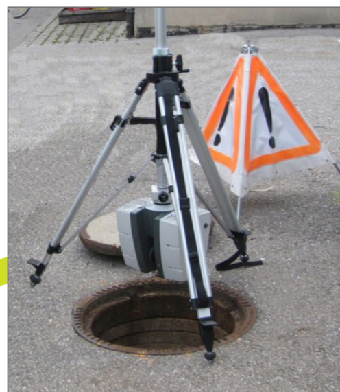
Detailliertes Schachtaufmaß idealerweise mittels Schachtscan
